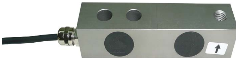
Один из 4 тензопреобразователей датчика усилия
