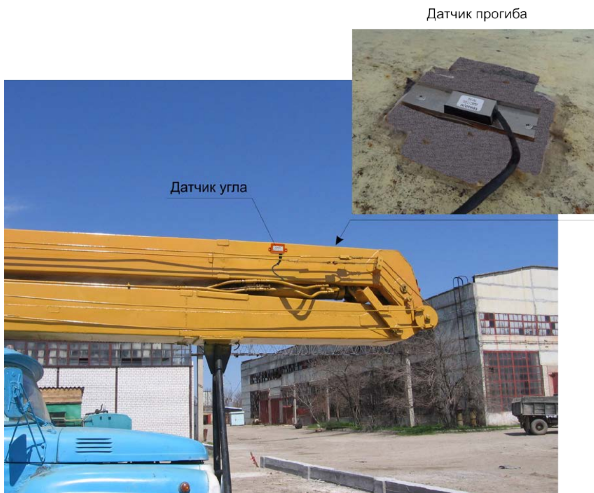
Рис.5 Размещение датчиков угла и прогиба
