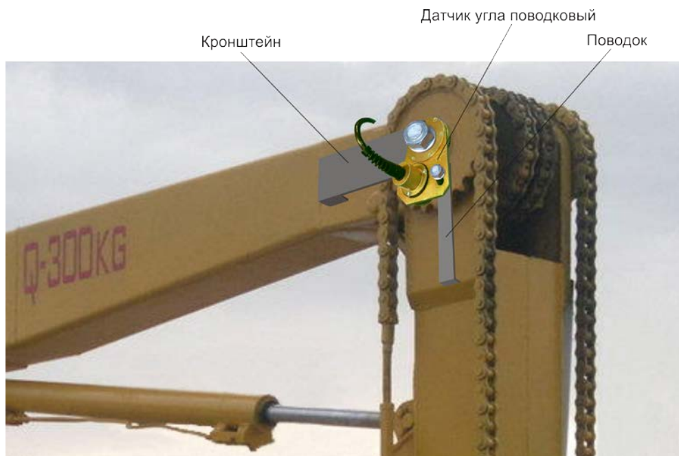
Рис.6 Размещение датчика угла поводкового
