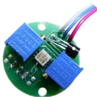
Рис. 7 Встроенный датчик угла 1 наклона стрелы системы АС-АОГ-01м +
