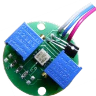
Рис. 7 Встроенный датчик угла наклона стрелы системы АС-АОГ-01м +
