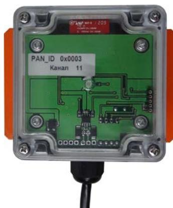
**Рис. 11****Приемо-передающее устройство радиоудлинителя системы АС-АОГ-01м+**
